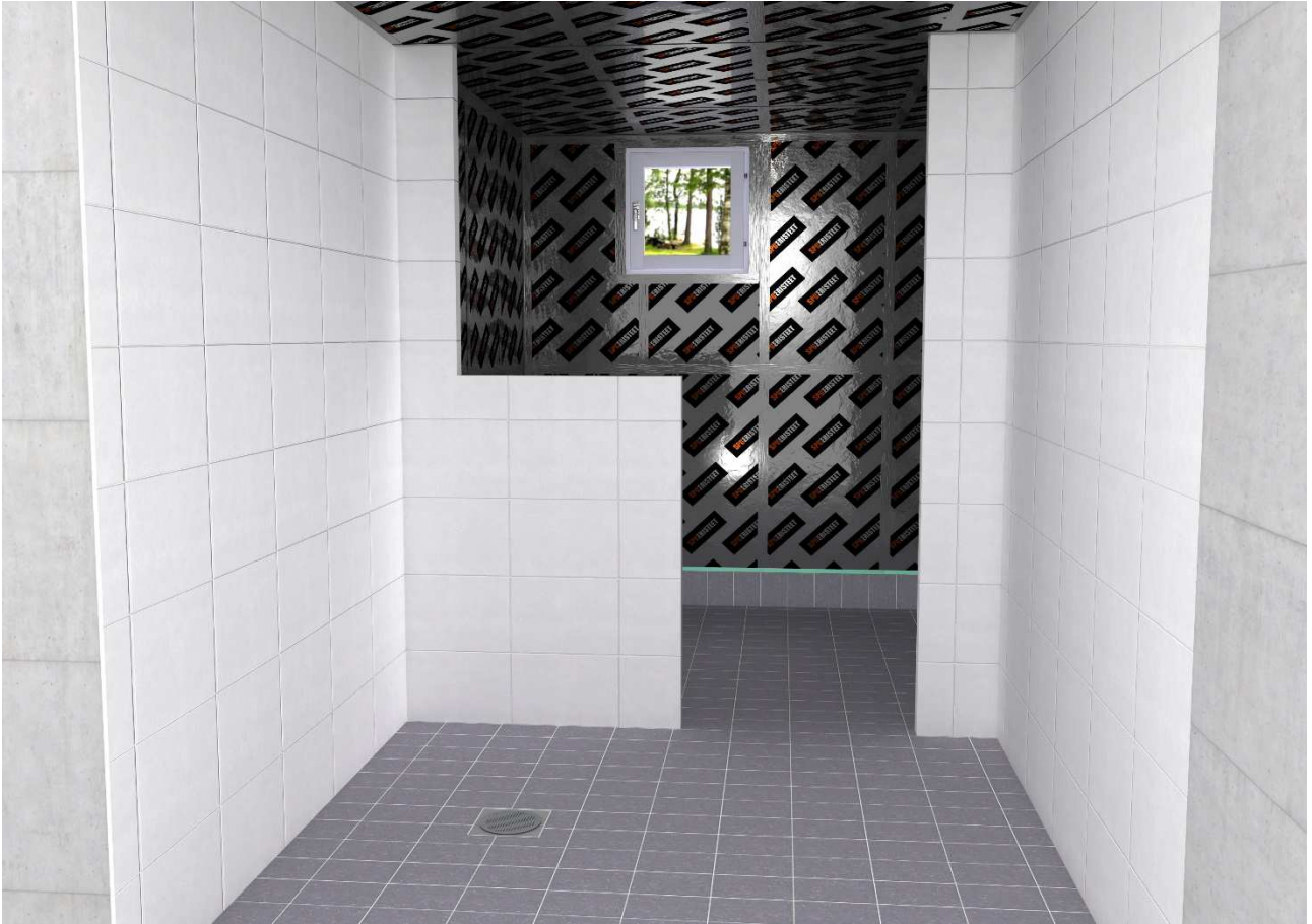
kuva 13. valmis lattian laatoitus
