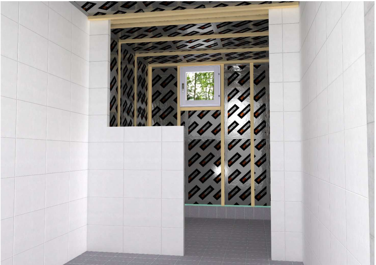
kuva 14. saunan seinän ja katon koolaus
